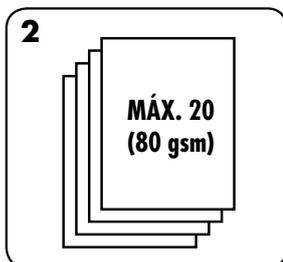
2. Perfore las hojas en partidas pequeñas para no sobrecargar la máquina ni exceder el esfuerzo del usuario.
