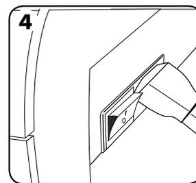
4. Instale el conductor en la máquina (el enchufe se encuentra en la parte posterior de la misma).
