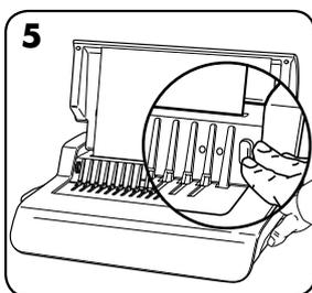
5. Perfore algunas hojas de prueba para comprobar la posición de la guía lateral.
