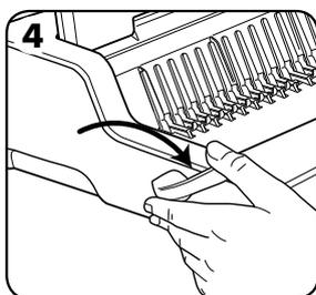
4. Tire de la palanca de apertura de canutillo hacia delante para abrir el canutillo.
