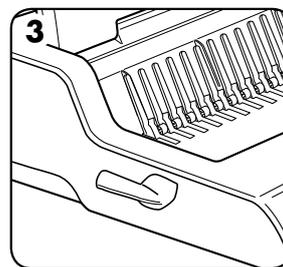
3. Inserte el canutillo de plástico en el mecanismo de apertura.
