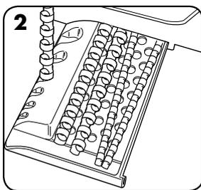
2. Seleccione el diámetro del canutillo correcto utilizando la bandeja de almacenamiento de canutillos.
