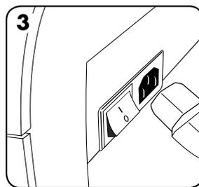
3. La máquina se proporciona con los conductores de alimentación para conectar. Seleccione el conductor correcto para la fuente de alimentación apropiada.
