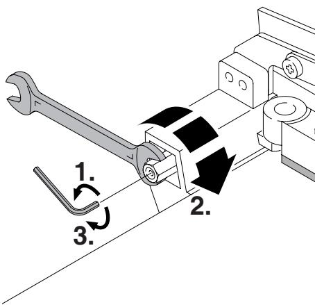
**DE** Die Maschine ist mit einer **Friktionseinrichtung** am Messerhebel ausgerüstet. Sie verhindert, daß der Messerhebel sich aus einer angehobenen Stellung selbstständig nach unten bewegt. Ist dies dennoch der Fall, so muß die Friktionseinrichtung wie folgt nachjustiert werden:
