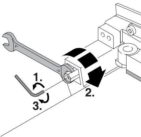
**PT** A máquina têm um **aparelho de fricção** suporte da faca não consegue movimentar para baixo por si. Ao fazer este movimento reajustar o aparelho de fricção da seguinte maneira:
