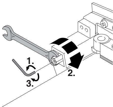
**NL** De machine is uitgerust met een **frictievoorziening** aan de meshouder. Deze zorgt ervoor dat de meshouder niet uit zichzelf neerwaarts beweegt. Indien dit toch het geval is, dan dient de frictievoorziening als volgt te worden nagesteld:
