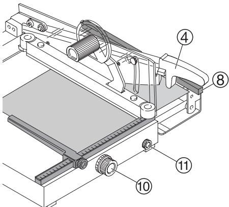
**NL** Het papier kan ook aan de vooraanleg ⑧ gelegd worden. Gewenste maat instellen met de meettrommel ⑩ en kan bij snedes met dezelfde afmetingen vastgezet worden d.m.v. een schroef (11).
