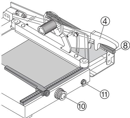
**NO** Frontanlegg H kan justeres for finskjæring av kutt inntil 10mm bredde. Det ønskede mål innstilles med justeringsskruen J og festes med låseskrue K for gjentatt skjæring. Kutt smalere enn 10mm er mulig fordi frontanlegget automatisk flytter seg ut når det skjæres.
