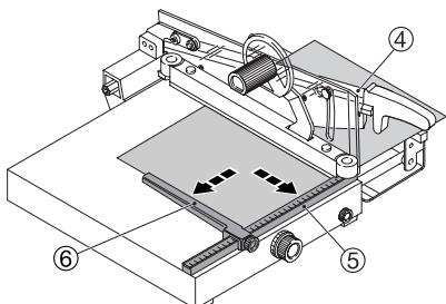
**DE** Messerhebel ④ anheben und Papier von links einlegen. Rückanschlag ⑥ und Seitenanschlag ⑤ ermöglichen eine präzise Papieranlage.
